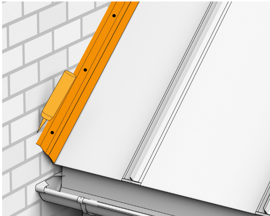
FIG. 38 MONTAREA BAREI DE DILATARE
