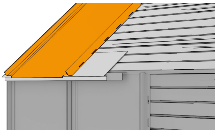
FIG.58 MONTAREA PANOURILOR PE VERSANTUL DE ACOPERIȘ
